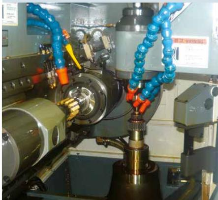
Tailleuse à commande numérique GH0 200 équipée de skiving
