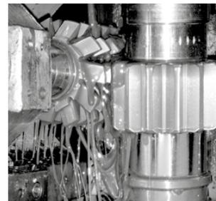
Taillage d'engrenages de la pièce unitaire à la moyenne série jusqu'au module 16.
